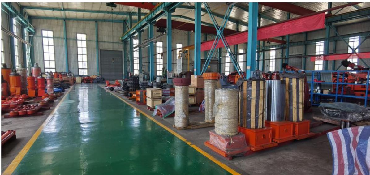
主要部件江苏佳煤机械有限公司掘锚机:掘锚机的原理是为了满足长壁开采技术的需要,加快巷道掘进,切割高度在2260[mm]到3450[mm]之间的煤层巷道。掘锚机使用电源作为动力。工作区采用液压支架支撑顶板,为作业人员提供舒适安全的工作环境。掘锚机规格和大零件:切割切割面,切割高度取决于螺栓连接的高度。切割高度不能大于螺栓连接的高度。切割平面的矩形宽度:5200毫米;铲板收缩后4700mm切割滚筒收缩后4700mm切割/支撑高度:2260毫米至3450毫米;降低顶梁2000mm掘锚机支护及时,且机器打锚索,减少劳动强度。徐州智能化掘锚机供应商家
